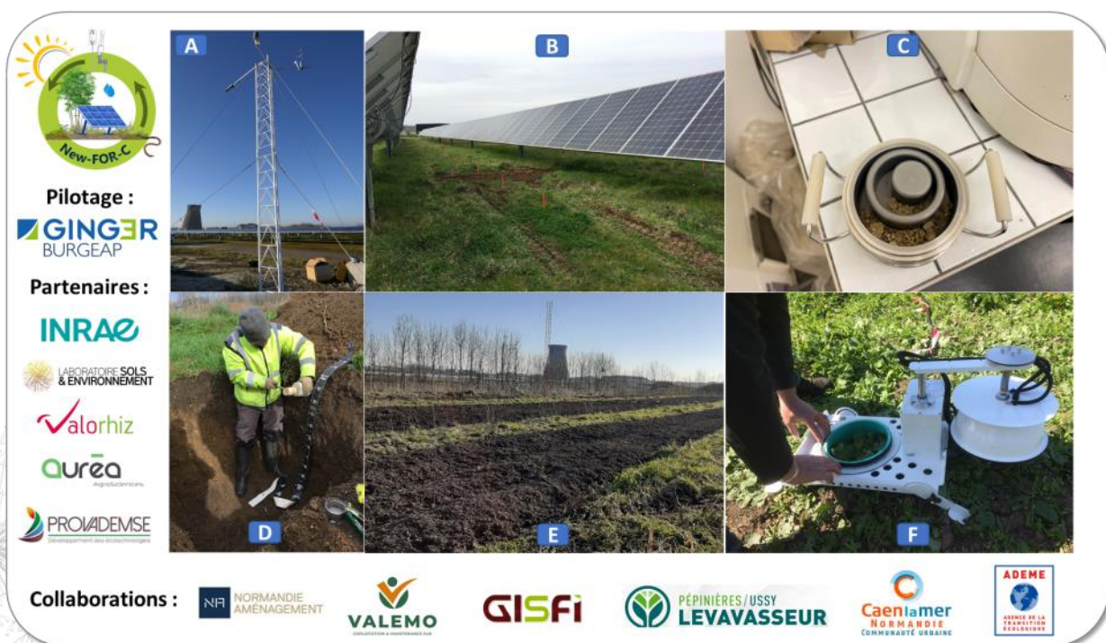
Photos du projet New-FOR-C, exemples de mesures réalisées : A. Mesures des flux de carbone, d'eau et d'énergie (FS), B. Caractérisation agropédologique des sols (FS), C. Préparation des échantillons (broyage au GISFI), D. Détermination de la densité apparente pour évaluer les stocks de carbone. E. Stratégie de végétalisation (TCR), F. Mesures de respiration du sol (TCR).
