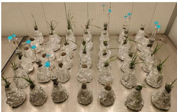
Photo de l'essai hydroponique de biodégradation des hydrocarbures en présence de B. thailandensis , de ray-grass et de biosurfactants, au lancement de son incubation en enceinte phytotronique (PEPLor)
